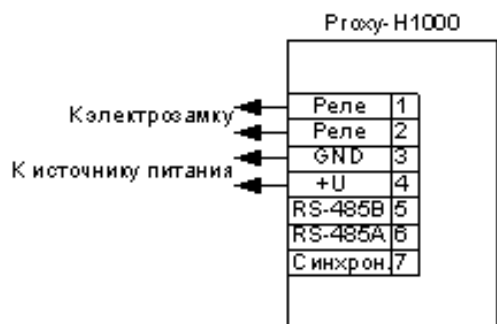
Схема соединений счетывателя
